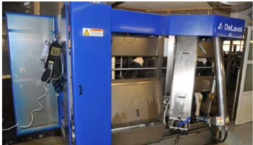
Til venstre på malkerobotten ses måleudstyret til metan-målingerne.
