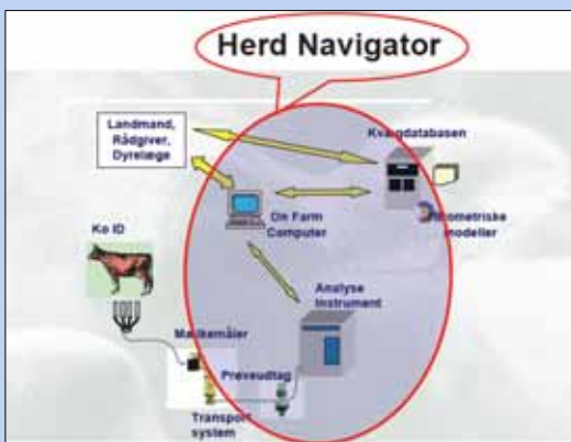
Opbygning af Herd Navigator. Mælken sendes til analyse-instrumentet, hvorfra måledata sendes til gårdens computer. Her behandles data i biometriske modeller udviklet i Biosens-projektet.
